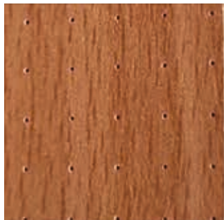
PANNELLO IN NOBILITATO MELAMINICO B;S2;d0 / IMPIALLACCIATO LEGNO SP. 14 MM . FORO D.0,5 MM PASSO 6 X 6 MM. TESSUTO FONOASSORBENTE NERO NELLA PARTE POSTERIORE.
