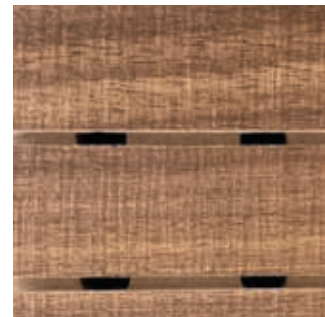
PANNELLO IN NOBILITATO MELAMINICO B;S2;d0/ IMPIALLACCIATO LEGNO SP.14 MM FORI POST PASSO 32 X 32 FRESATURA PASSO 32-3 . TESSUTO FONOASSORBENTE NERO NELLA PARTE POSTERIORE.
