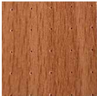
PANNEAU DE BOIS DE MÉLAMINIUM B;S2,dO / COUCHE DE BOIS 14 MM D'ÉPAISSEUR DIAMÈTRE DU TROU 0,5 MM PAS 6 X 6 MM. TISSU NOIR INSONORISANT À L'ARRIÈRE.
