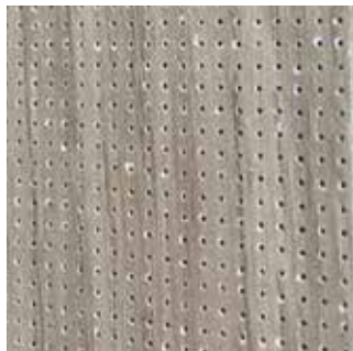
PANNEAU DE BOIS DE MÉLAMINIUM B;S2,dO / 14 MM D'ÉPAISSEUR DIAMÈTRE DU TROU 0,5 MM PAS 2 X 2 MM. TISSU NOIR INSONORISANT À L'ARRIÈRE.
